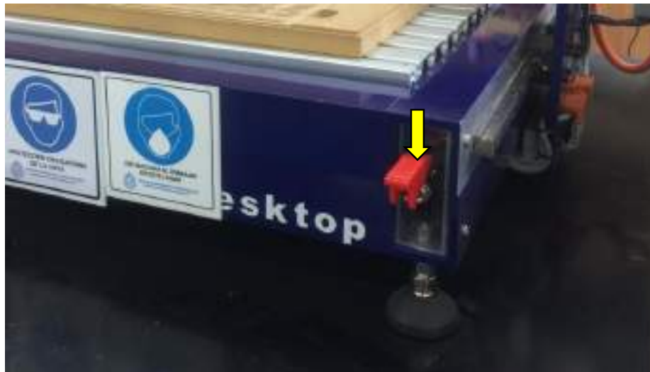
Figura 6-Switch de apagado de emergencia. Hacia arriba encendido. Hacia abajo apagado. Fuente propia
