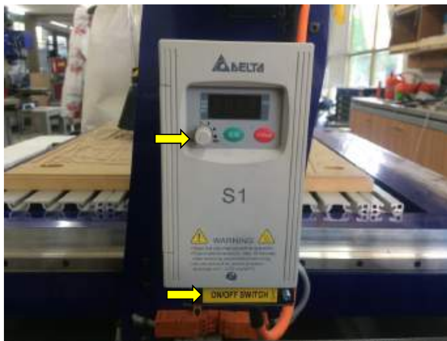
Figura 7-Control de Potencia de la Shopbot Desktop. Fuente propia.
